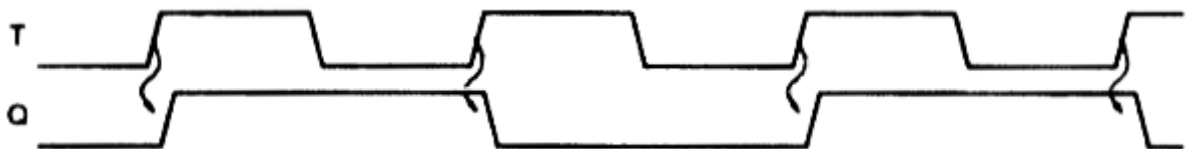
Рис. 23. Функциональное поведение переключающегося по фронту T-триггера.
